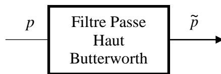
Figure III.9: Schéma de principe du filtre utilisé pour l'extraction des composantes harmoniques
